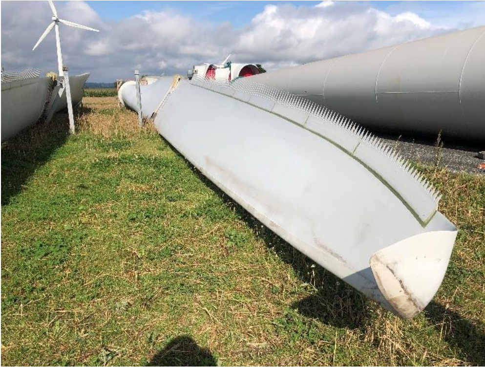
Figure 28:Exemple d'une pale équipée de "serrations" - Parc éolien de Lanfains -Kallista Energy
